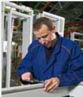
Neben den Fremdüberwachungen, die im Zuge von Gütesicherungen vorgenommen werden, sichern Hörmann Mitarbeiter in der Produktion und in der Qualitätskontrolle einen sehr hohen Qualitätsstandard. In der täglichen Produktion werden unsere Zargenelemente ständig durch Stichproben auf ihre Funktion und Verarbeitungsqualität überprüft.
