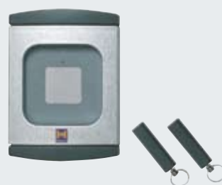
Transpondérové tlačítko TTR 100, TTR 1000 Komfortní způsob otvírání vrat: Jednoduše přidržíte klíč transpondéru se svým osobním kódem asi 2 cm před čtecím zařízením. Bezdotykové! To je mimořádně praktické ve tmě. Vhodné pro max. 100 klíčů transpondérových klíčů (TTR100), popřípadě 1000 klíčů transpondérových klíčů (TTR1000). Dodány jsou dva transpondérové klíče.
