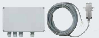
Dvoukanálový reléový přijímač HER 2 Se 2 bezpotenciálovými reléovými výstupy, frekvence 868 MHz, IP 65, napájecí napětí 24 V DC/230-240 V AC, samostatná anténa pro venkovní použití (IP 65), v hliníkové skříni bezpečné proti sabotáži, s přípojovacím vedením o délce 7 m, třívodičovým, vyhodnocovací jednotka pro vnitřní prostor
