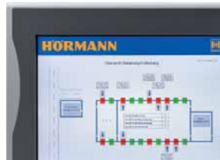
Kontrolované průběhy díky vizualizaci pomocí panelu obsluhy nebo webové aplikace
